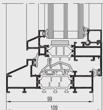
Das einzigartige Fenster- und Türsystem CS 38-SL von Reynaers wird in einer weiterentwickelten Version neu aufgelegt. Mit ultraschlanken Profilen und einer verbesserten Energieeffizienz sind SL 38 und SL 38-HI würdige Nachfolger. Durch die Kombination von hervorragenden Wärmedämmwerten, einem klaren Design und all den Vorzügen des Werkstoffs Aluminium erfüllt das System höchste architektonische Ansprüche.
